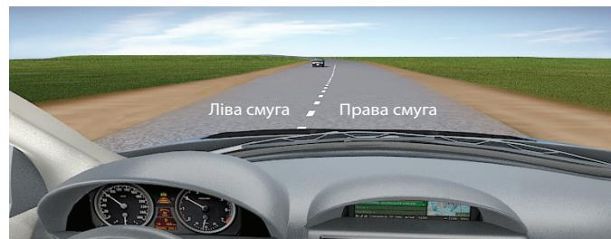
У сучасних механічних транспортних засобах місце водія і кермо, як правило, розташовані так, щоб водій міг краще контролювати рух відносно зустрічного транспортного потоку. Так, в автомобілях, призначених для правостороннього руху, кермо має бути розташоване ліворуч, а у призначених для лівостороннього руху — праворуч.
