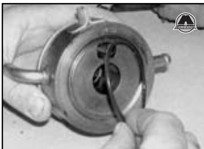
7.5а. Используйте новое уплотнительное кольцо при установке масляного радиатора.
