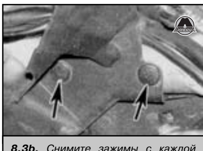
8.3б. Снимите зажимы с каждой стороны (указаны на иллюстрации стрелками)...
