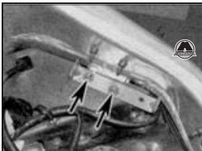
8.2б. Отверните болты крепления (указаны на иллюстрации стрелками) с каждой стороны и снимите пластину.
