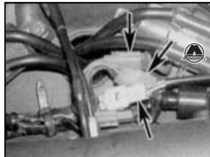
8.3а. Отсоедините электрические разъемы (указаны на иллюстрации стрелками).
